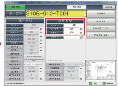
③ RFID읽기 버튼을 눌러 공구의 RFID 칩 내의 정보를 읽어 들인다.
